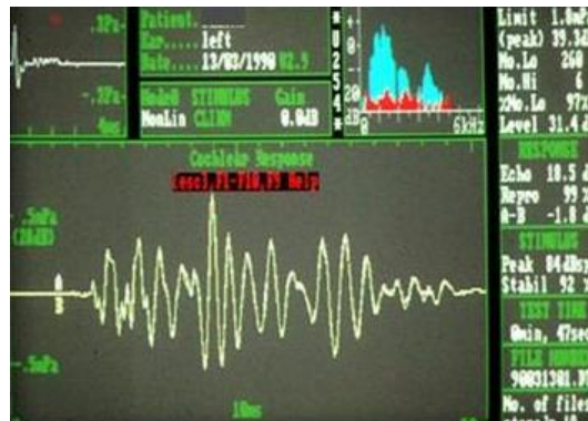
Figure 23 : Visualisation des réponses cochléaires à l'aide du système Otodynamics Analyser ILO88
