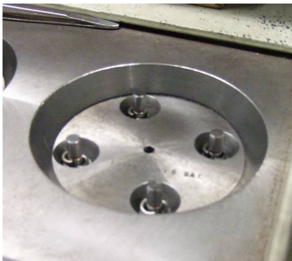
Photo 7 et 8 Positionnement des demi-lunes autour des soupapes
