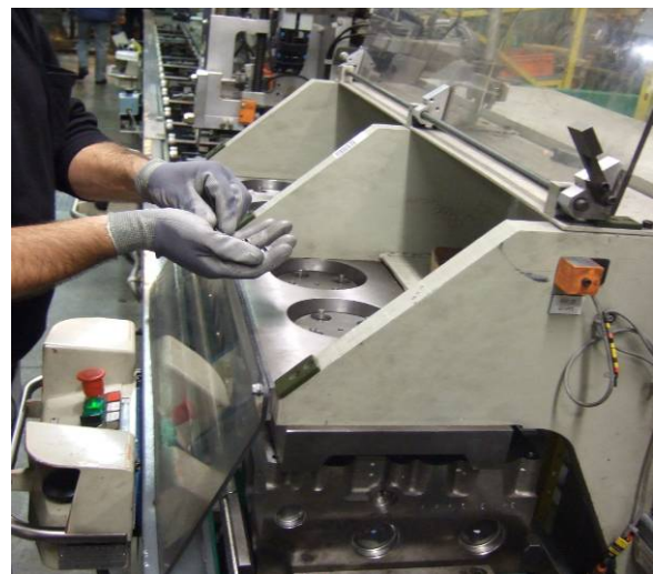
Photo 7 et 8 Positionnement des demi-lunes autour des soupapes
