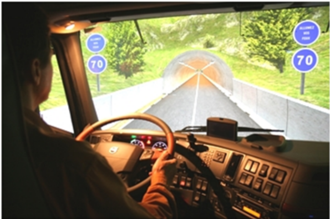
Image 18 : Poste de conduite du SCOOP (cabine Volvo FH12)
