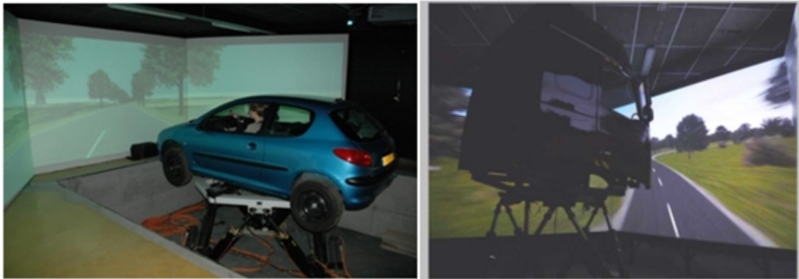
Image 14 : Simulateur dynamique SHERPA du LAMIH-CNRS à gauche 63 et Simulateur dynamique de camion de Renault Trucks à droite
