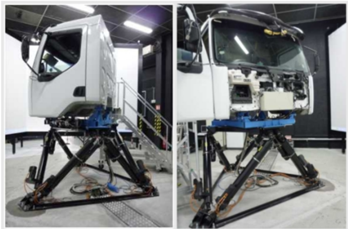
Image 17 : Plate-forme dynamique du SCOOP (Cabine Renault MIDLUM du projet VIVRE2)
