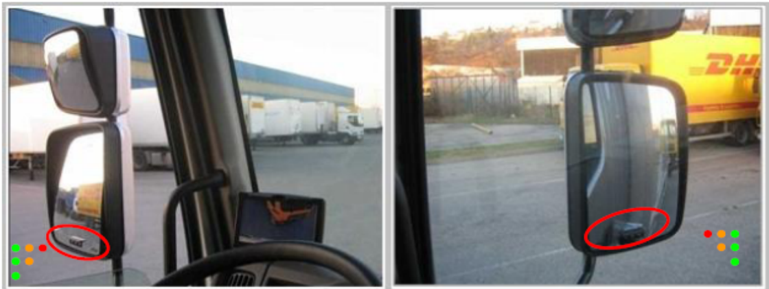
Image 10 : Position des diodes dans les rétroviseurs du camion FIDEUS
