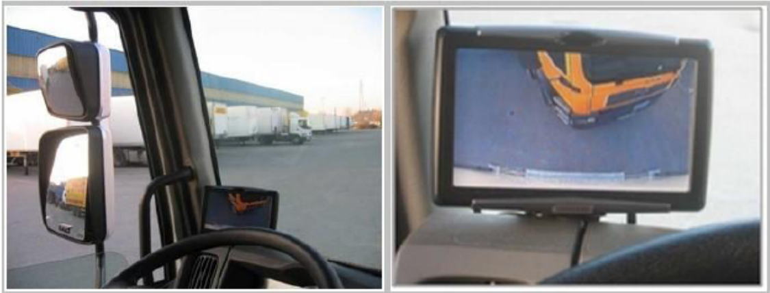
Image 9 : Interface visuelle pour la vision arrière du camion FIDEUS
