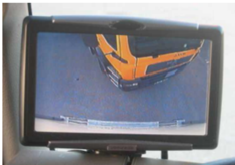
Image 38 : Affichage de la vue arrière du camion sur l'écran du GPS
