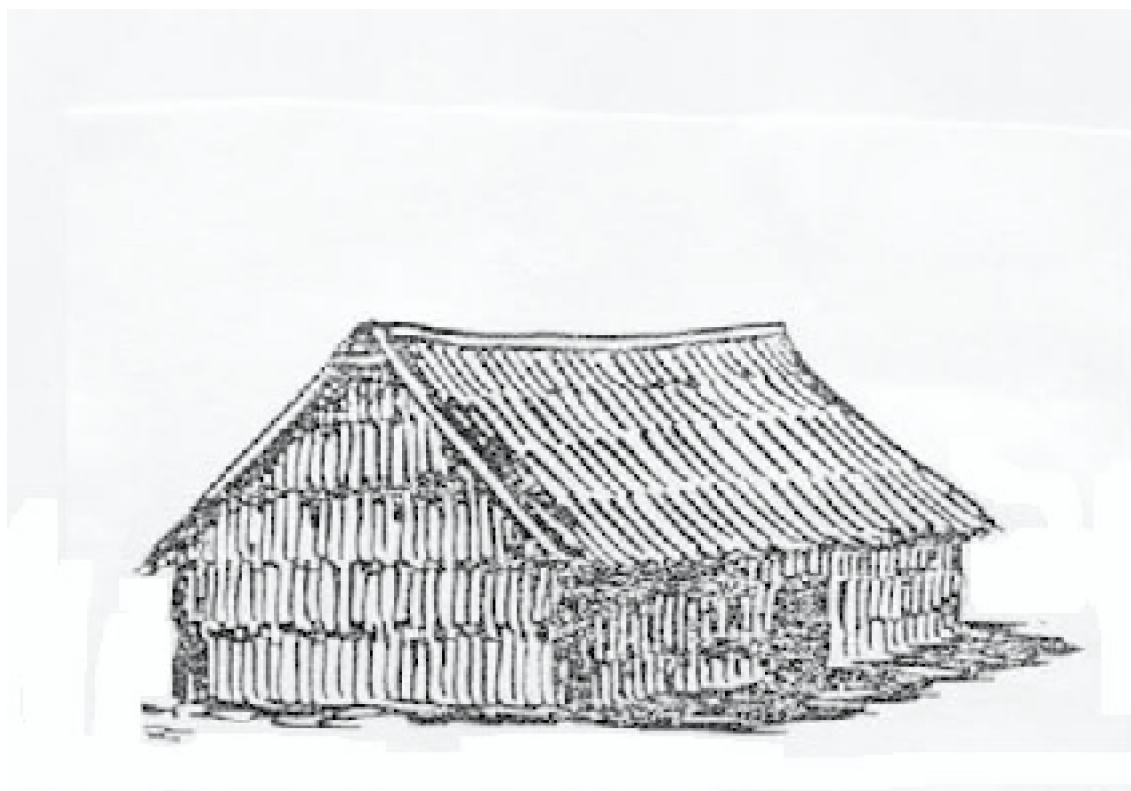
Fig. 2 : Les qabisa-s du nord du Maroc et du Gharb. A- Vue d'une qabisa de plan rectangulaire, constituée d'un maillage de roseaux entrelacés.
