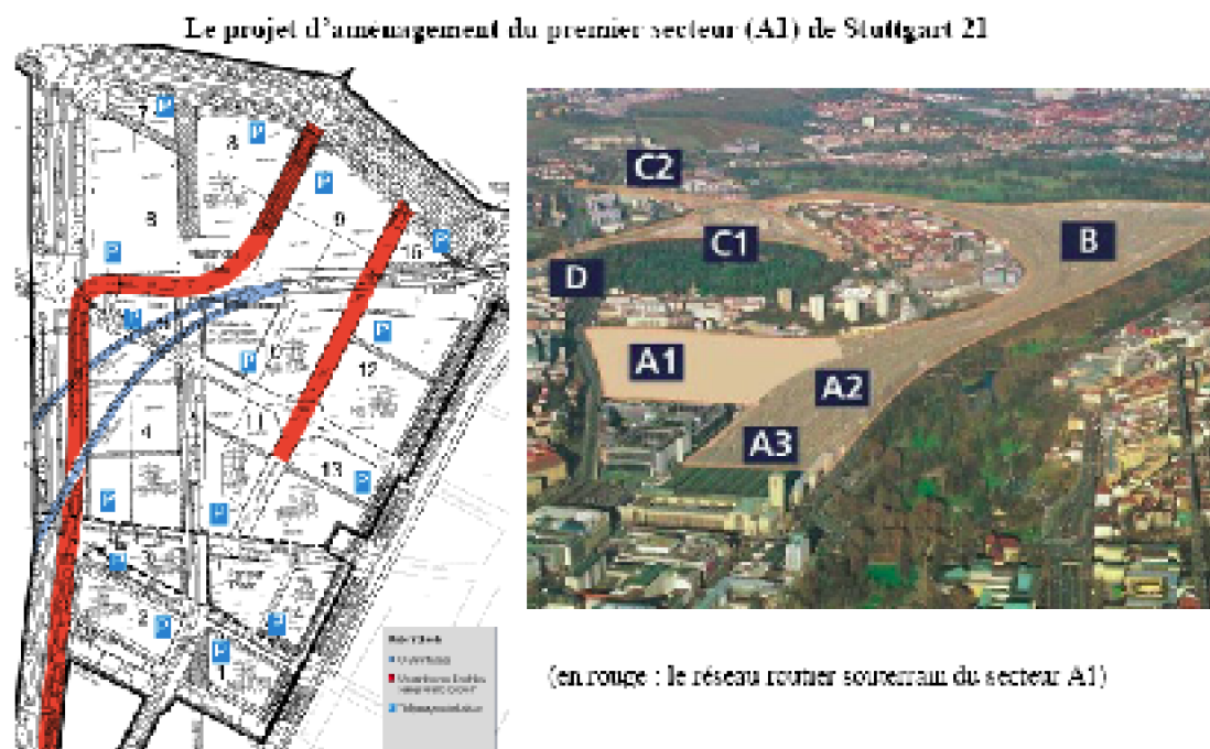
Figure 78- Le projet d'aménagement du premier secteur (A1) de Stuttgart 21 (en rouge : le réseau routier souterrain du secteur A1)
