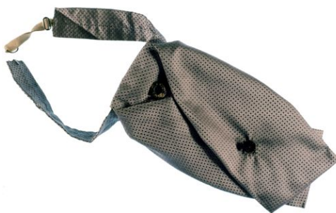
Fig. 47. « Photo-Cravate 1890 », appareil dissimulé, E.Bloch & Dessoudeix. Les 6 châssis-plaques sont fixés sur une chaîne tournante 25x25 mm. Objectif achromatique, obturateur à volet simple. Métal, peint en noir.
