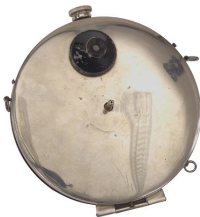
Fig. 48. « L'Invisible » 1890, appareil dissimulé, fabrication française similaire à l'appareil américain "Plastron" de Stirn. Plaque ronde de 14 cm, rond de 4cm de diamètre, objectif rectilinéaire, obturateur à secteur circulaire. Métal nickelé, dos à charnière. Exposé au Musée Niépce de Chalon-sur-Saône 257 .
