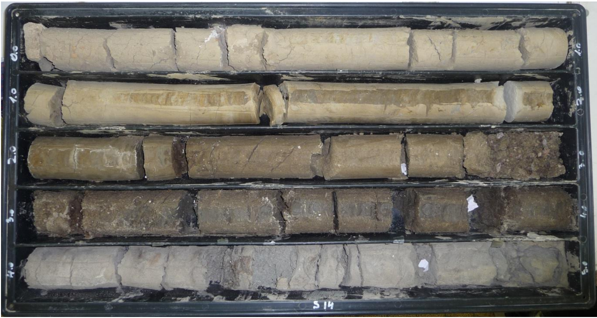
Annexe 2 : Photographie de la carotte TR 14 entre 0 et 5 m de profondeur
