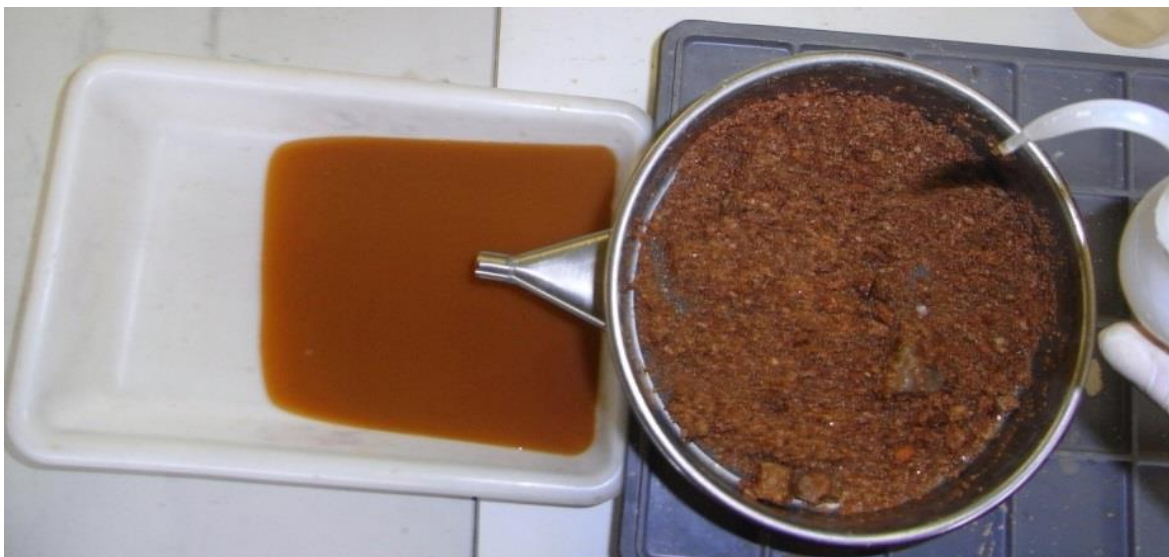
Figure 2.3 : Mesure de la texture sédimentaire par un tamisage humide.
