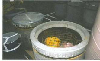
Conteneur de béton renfermant des déchets technologiques : gants, outils, tenues de protection.
