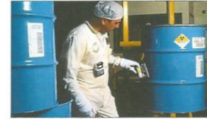
Contrôle de radioactivité des fûts de déchets de faible activité sur le site de Nogent-sur-Seine. Leur code barre permet de les répertorier et de connaître leur contenu et leur origine.
