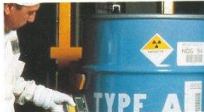
Contrôle de la radioactivité des fûts contenant des déchets radioactifs dans les centrales nucléaires
