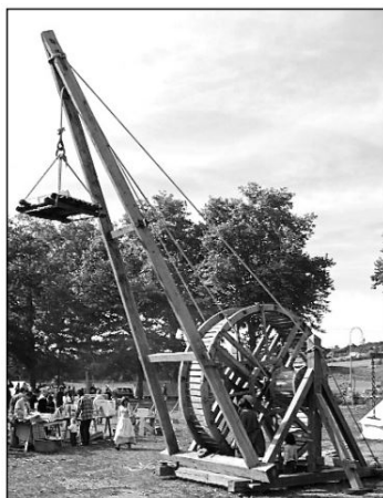
Fig. 133 : Chèvre à cabestan. La chèvre photographiée est une réplique de celles utilisées au Moyen Âge. Elle a été réalisée par Pascal Waringo de l'association « Les bâtisseurs médiévaux ».
