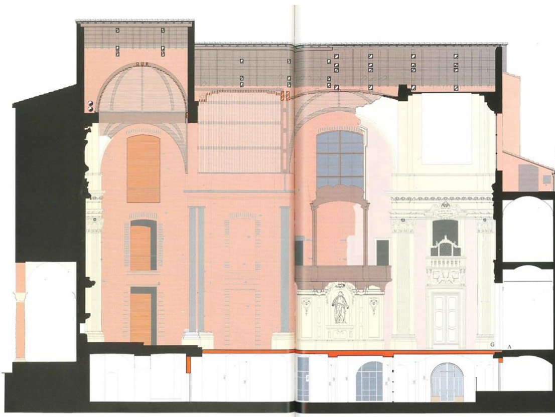
Fig. II.51 Bologne, chapelle S.-Filippo-Neri. Ci-dessus, coupe longitudinale, état projeté, vers le mur Sud, celui qui a été détruit et reconstruit en brique dans la 1 re phase de travaux (1950). A gauche, les colonnes en béton, l'autel dans le fond, à droite la partie du XVIII e siècle restaurée dans la 2 ème phase de travaux. Le système de voûtes ajourées en bois permet d'installer des appareils techniques (ventilation, éclairage), sous les charpentes.
