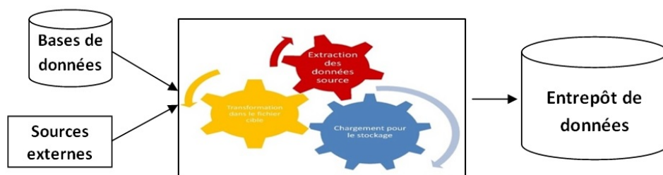
Figure 4.4 – Une présentation schématique du processus ETL
